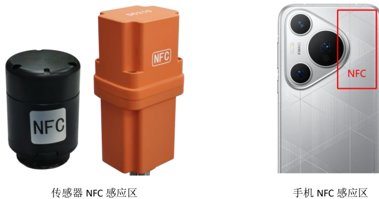
图 19. 传感器与手机 NFC 感应区
