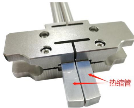
图 9. 导波杆探头热缩管
