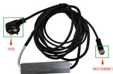
图 10. 电源线接线示意图
