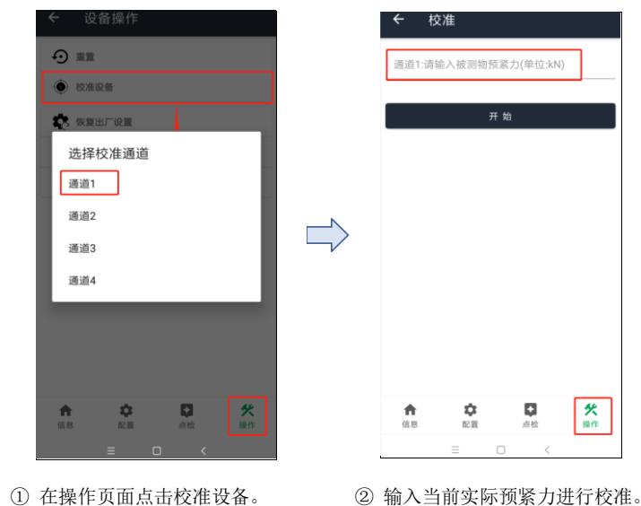
图 33. IoT Palm 手机 APP 对采集器选定通道进行校准
