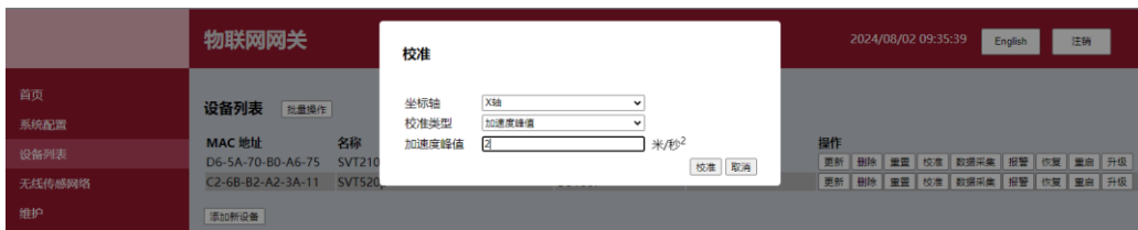
图 42. 校准 SVT 系列传感器
