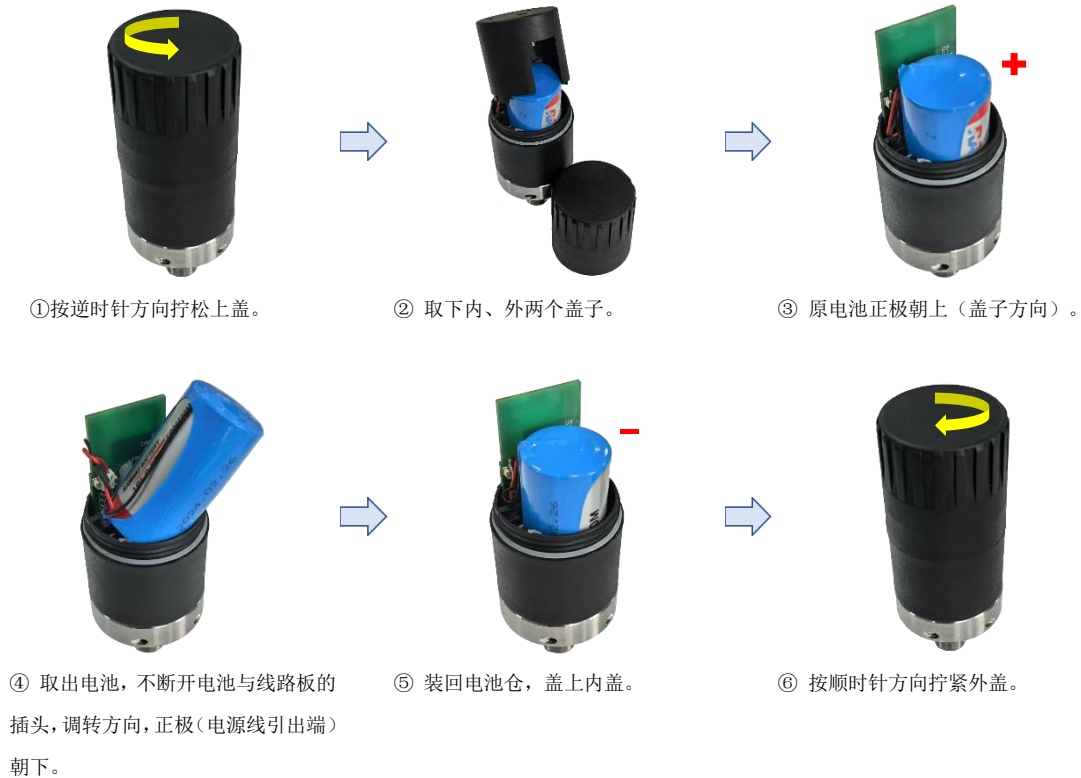
图 3. 电池倒置安装示意图
