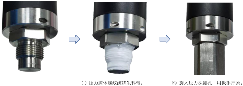
图 4. 传感器安装示意图
