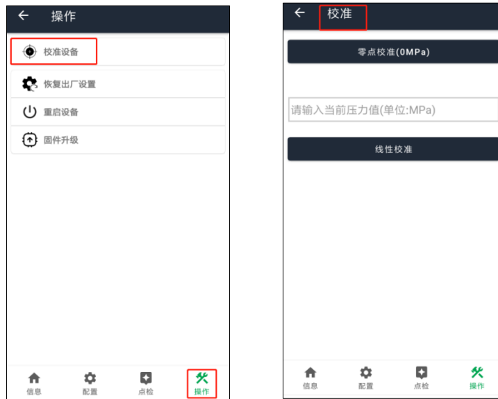
图 62. IoT Palm 手机 APP 对传感器进行校准
