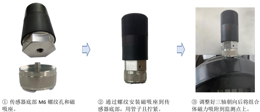
图 9. 马蹄形磁吸安装示意图
