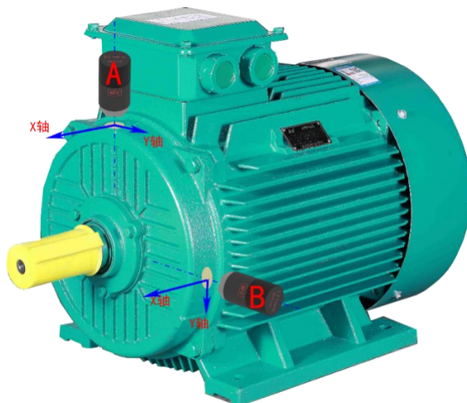
图 4. 传感器安装时三轴朝向示意图
