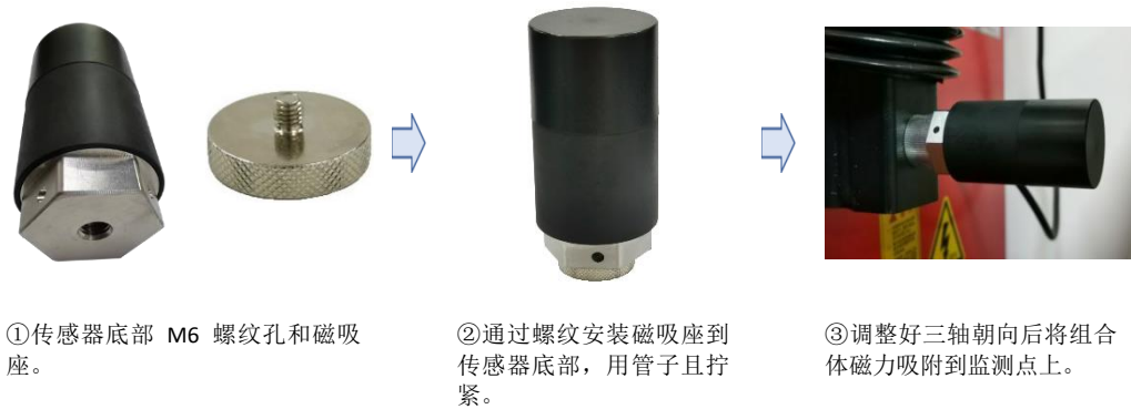
图 8. 平面型磁吸安装示意图
