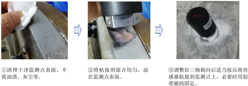
图 7. 粘接安装示意图
