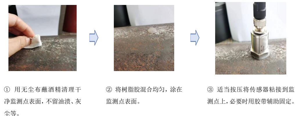
图 5. 粘贴安装示意图
