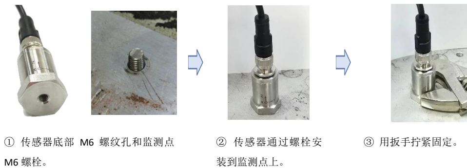
图 4. 螺柱安装示意图
