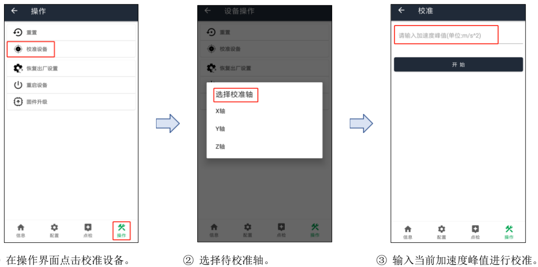
图 10. IoT Palm 对传感器进行校准
